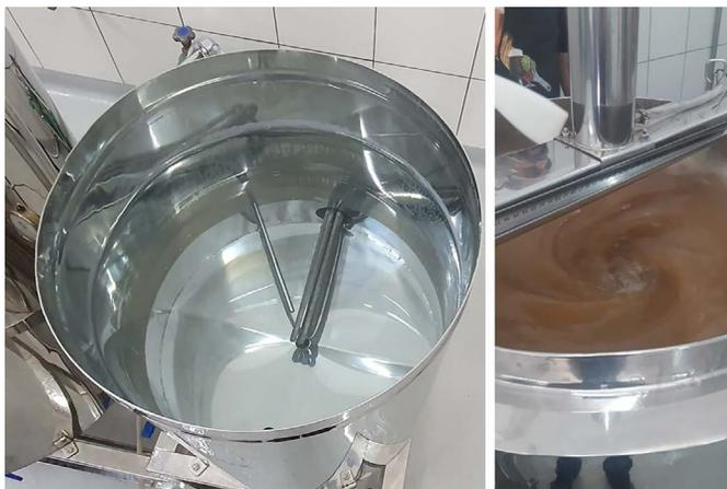
Figura 4 - A) Ebulidor utilizado no processo de produção da cerveja e B) Fase de *whirlpool*, mostrando o movimento circular do líquido.
