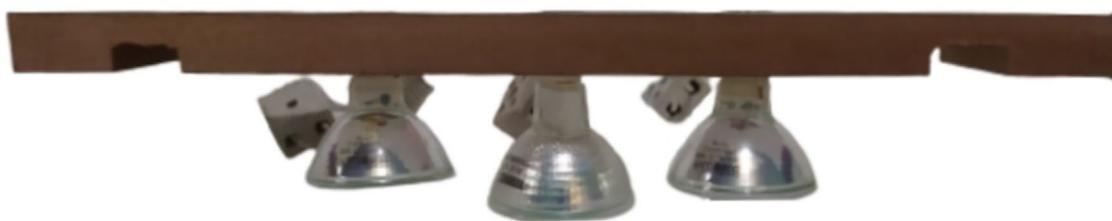
Figura 5 - Esquema da montagem das lâmpadas no suporte de MDF.
