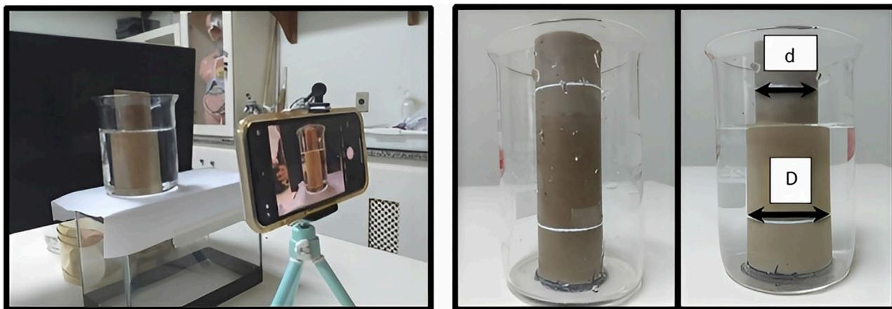
Figura 3 - a) Posicionamento da câmera do celular em relação ao béquer; b) cano de PVC imerso em um béquer vazio (imagem da esquerda) e cano de PVC imerso na solução de glicose de 0,4 mol/L (imagem da direita).
