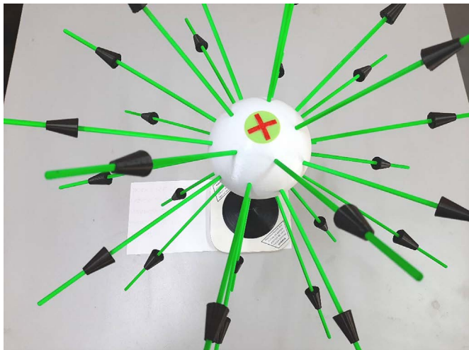
Figura 1 - Representação das linhas de força de um campo elétrico de um portador esférico de carga elétrica positiva. A maquete tem escrito em sua base, em tinta e em braille: “Representação das linhas de campo elétrico de uma carga pontual positiva”.
