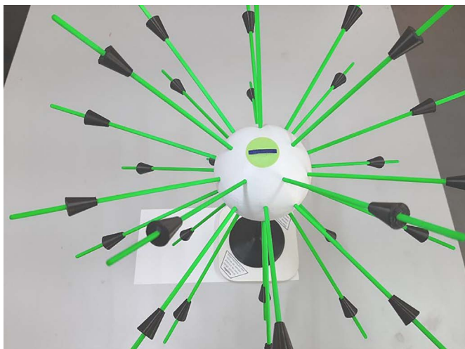
Figura 2 - Representação das linhas de força de um campo elétrico de um portador esférico de carga elétrica negativa. A maquete tem escrito em sua base, em tinta e em braille: “Representação das linhas de campo elétrico de uma carga pontual negativa”.
