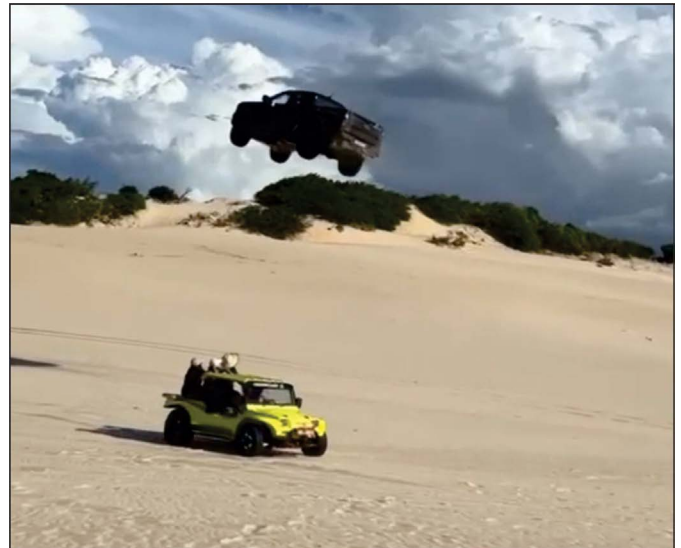
Figura 1 - Quadro do vídeo correspondente ao instante t_H em que o veículo atinge a altura máxima H do salto. A altura h do veículo nesse quadro do vídeo foi utilizada como referência métrica para a construção da trajetória parabólica do movimento no ar. Fonte: Adaptada da Ref. [4].
