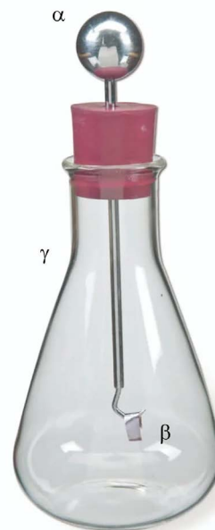
Figura 3 - Modelo de eletroscópio apresentado nos livros didáticos. Fonte: https://www.arborsci.com/products/electroscope .
