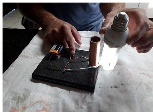
Figura 19 - Lâmpada fluorescente sendo acesa sem fio pela mini bobina de Tesla.
