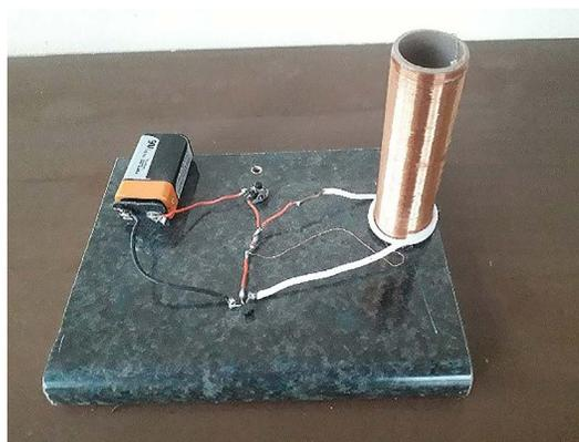
Figura 17 - Mini bobina de Tesla montada.
