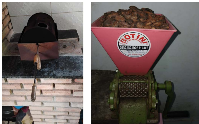
Figura 7 - Processo de torrar, descascar e triturar as amêndoas de cacau.
