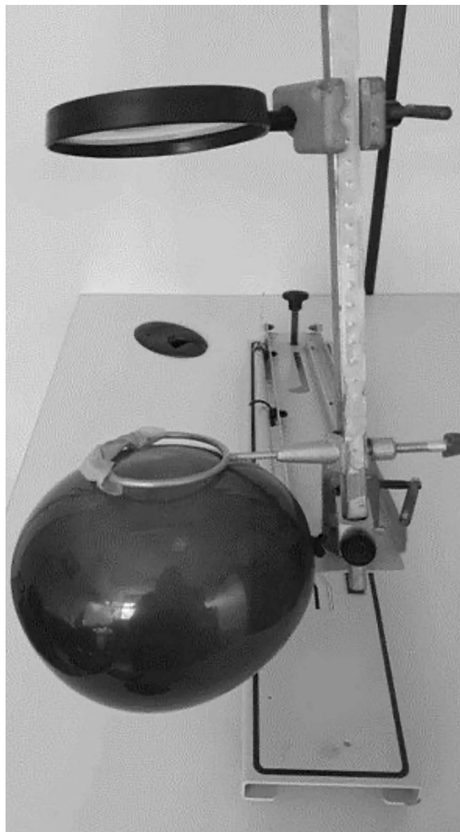
Figura 3 - Detalhe da lente e da marcação em braille na barra lateral do experimento adaptado da Ref. [2].
