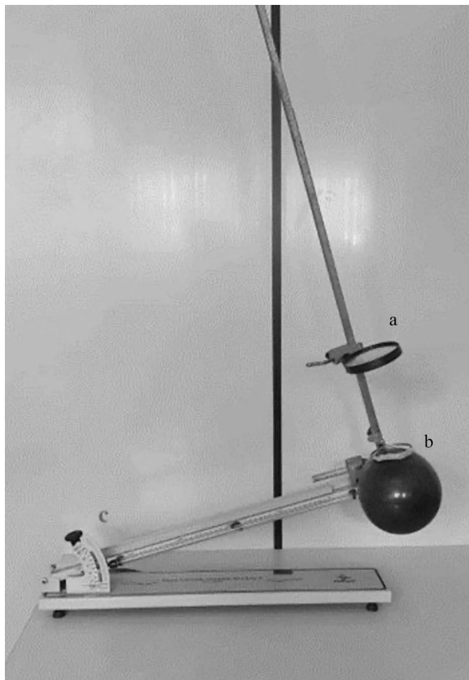
Figura 2 - Experimento adaptado para medição da distância focal de uma lente convergente: (a) lente convergente fixada com garra a uma haste com régua em braille; (b) balão fixado no foco da lente; (c) plano inclinado com ângulos em braille para ajustar a chegada dos raios solares paralelos à lente [2].
