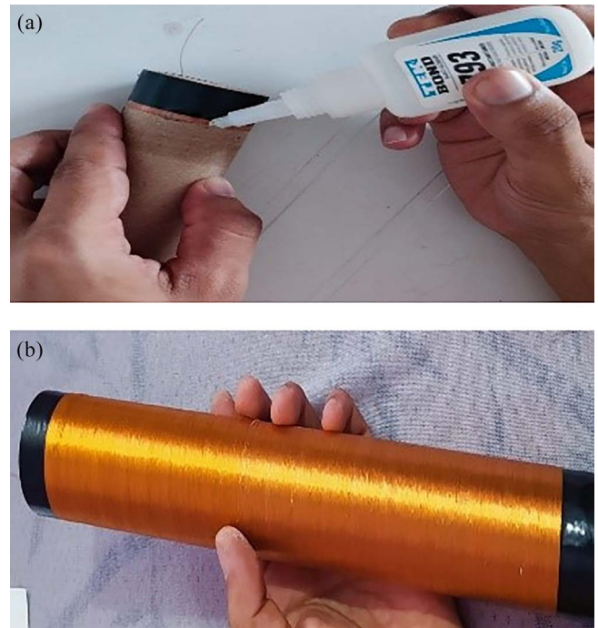
Figura 2 - Construção da bobina secundária.
