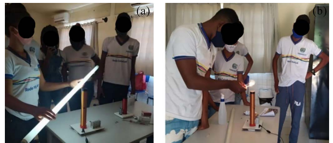
Figura 5 - Ionização da lâmpada fluorescente e exibição da capacidade da bobina de inflamar um palito de fósforo.
