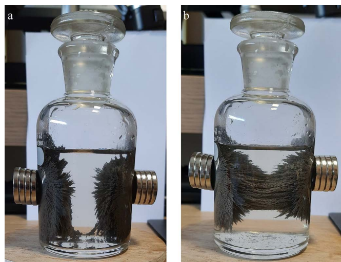
Figura 6 - a. Limalhas de ferro diluídas em água, com polos dos ímãs posicionados de modo a promover repulsão. Face norte de ambos para a parte interna da superfície de vidro. b. Limalhas de ferro diluídas em água com polos opostos posicionados na superfície interna do vidro, promovendo atração.
