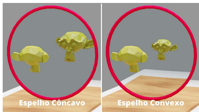
Figura 9 - Simulação da formação de imagens por espelhos esféricos: à esquerda, espelho côncavo produzindo imagens ampliadas; à direita, espelho convexo gerando imagens reduzidas. A cena ilustra como o Blender pode representar diferentes configurações ópticas de acordo com os princípios da óptica geométrica.
