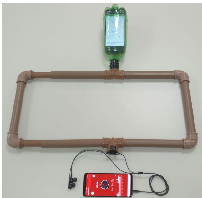
Figura 5 - Trombone de Quincke finalizado, em uso.
