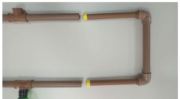
Figura 3 - Detalhe do encaixe da parte móvel na parte fixa do interferômetro.
