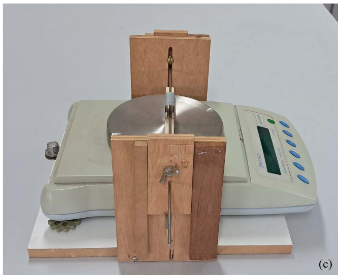
Figura 5 - Vista do corte lateral da montagem utilizada para estudar a força magnética e fotos da montagem.
