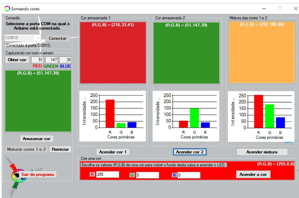
Figura 3 - Tela do programa Somando Cores em uma situação típica do experimento, mostrando as cores capturadas pelo sensor e a mistura entre elas.
