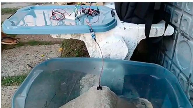
Figura 7 - Sistema de alerta de ruptura de barragem acoplado na parte superior do modelo de barragem de aterro.
