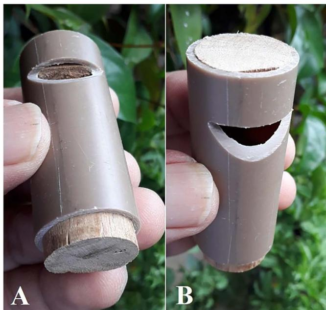
Figura 3 - Detalhes da embocadura e do êmbolo de um apito típico (tubo PVC marrom-2). A) Extremidade do êmbolo. A parte de madeira para vedação está parcialmente retirada para mostrar seu encaixe; B) Detalhe da região de sopro (pequena fenda entre a madeira e a parede interna do tubo) e do corte oblíquo compondo a região de geração do som. O dedo polegar dá a ideia da dimensão do apito.
