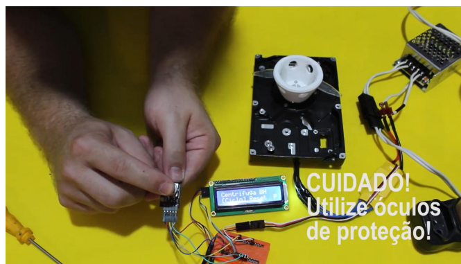
Figura 10 - Montagem completa da centrífuga com HD.
