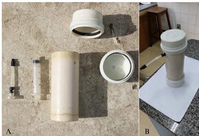
Figura 2 - A) Partes da câmara bórica; B) Câmara montada com o tubo de acesso.
