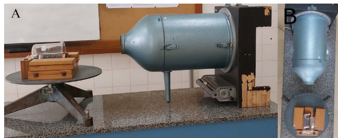
Figura 6 - A) Vista lateral do túnel de vento com o smart-phone posicionado no interior de um bquer de 500 mL; B) Vista superior da montagem.
